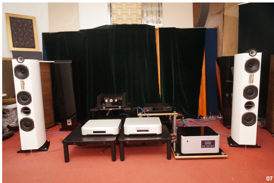
07. 本次聆聽環境位於本刊二號試聽間，環境大約七坪大小，喇叭擺位選擇減少Toe In角度與拉大喇叭之間的距離，換取更寬廣且立體的音場表現。
