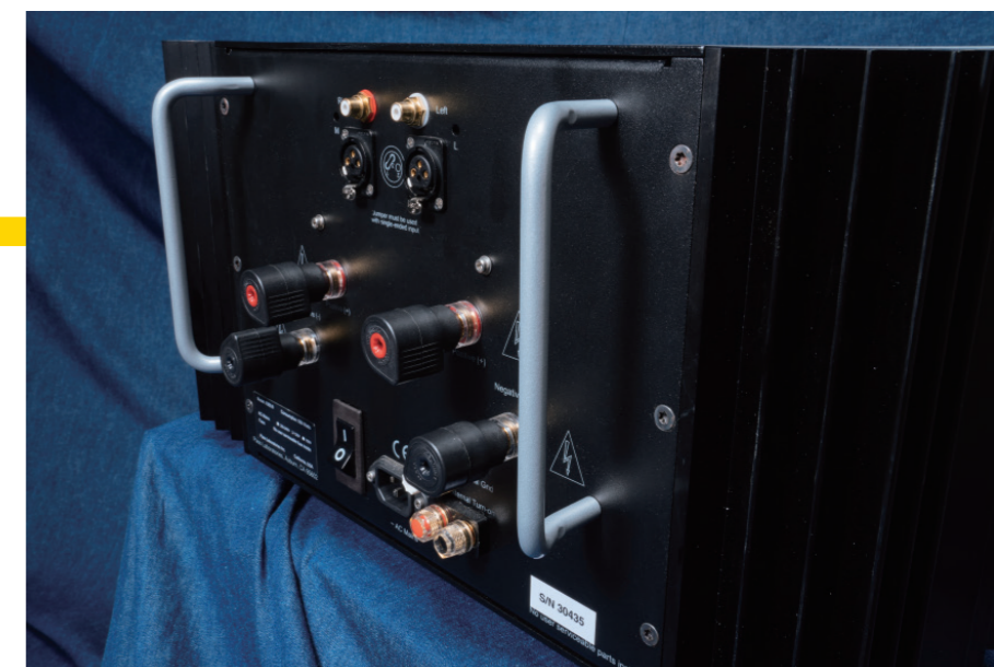
X-350.8配置了超大型的揚聲器接線端子，並且配置了平衡與非平衡輸入端子各一組。
