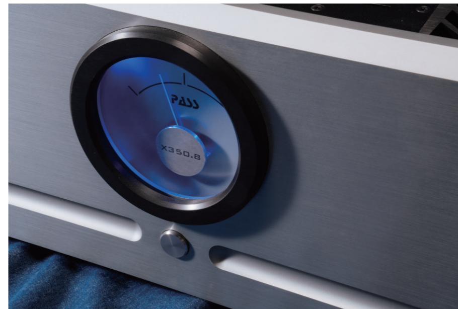
X350.8後級面板上設有大型的偏流表頭，大功率輸出時偏流有所增減可在錶頭上觀察出來。
