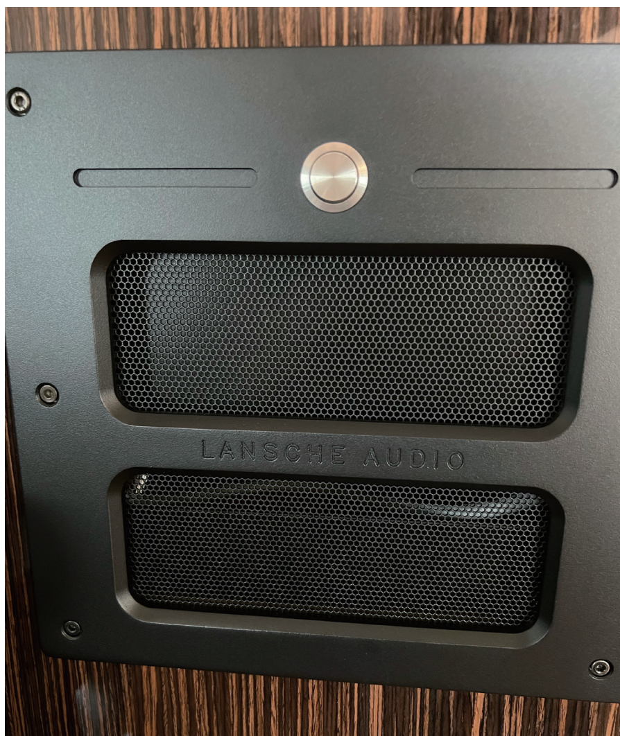
● No. 5.2的背板上方電漿高音散熱處有一個按鈕，那就是電漿高音的開關。
