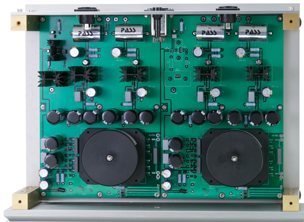
↑ Xs Pre的外接電源箱內部有二套獨立電源供應，分別供應左右聲道線路所需。不僅變壓器容量大，濾波電容的容量也大，可見電源絕對是好聲之鑰。
