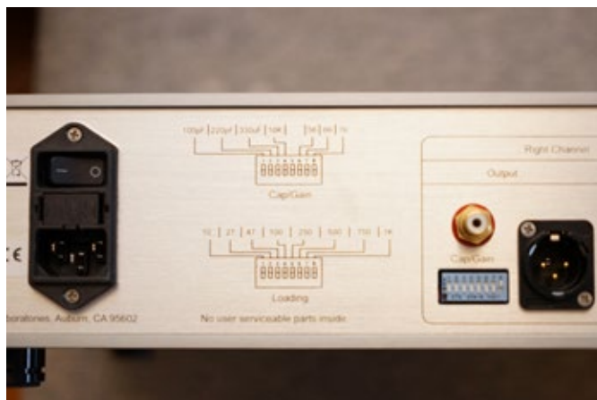
電源母插旁有圖示的DIP開關數值，用家可以任意調整。
