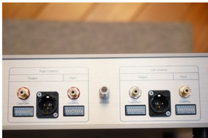
背板上有DIP開關，每聲道輸出端子左邊是用來調整增益與容抗的DIP，右邊是用來調整阻抗匹配的DIP。
