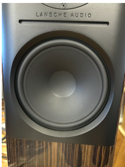
●這是200mm的中低音單體振膜，表面有細微粒子。
