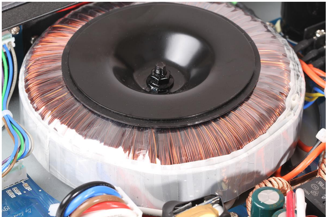
STA 使用的大型環形變壓器具有特殊的繞組方式，比同體積一般變壓器高出 30% 容量。
