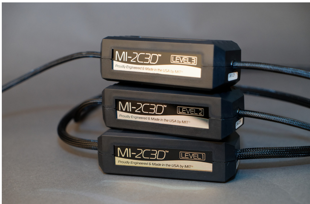
三個等級的黑盒子尺寸完全相同，Level 1的等級最高，Level 3最入門。請注意Level 1的線徑比另兩個等級略粗。
